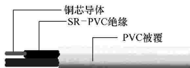
图 3-12 AVVR 或 RVV 聚氯乙烯 绝缘软电缆结构
