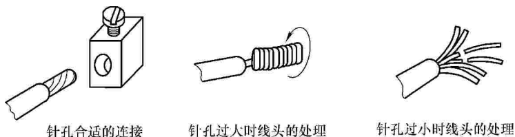
图 2-33 多股芯线端头处理方法
