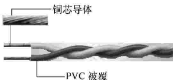
图 3-15 AVRS 绞型双芯电源线、RVS 铜芯聚氯乙烯绞型连接电线结构
