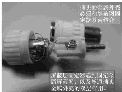
图 3-42 插头组装示意图
