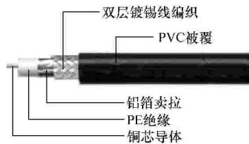
图 3-10 SYWV（Y）、SYKV 有线电视、宽带网专用电缆结构
