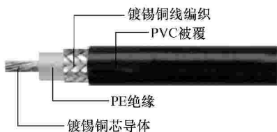
图 3-11 RG-58-96#-镀锡铜 编织-50Ω 电缆结构
