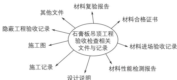
图8-5 石膏板吊顶工程验收检查相关文件与记录
