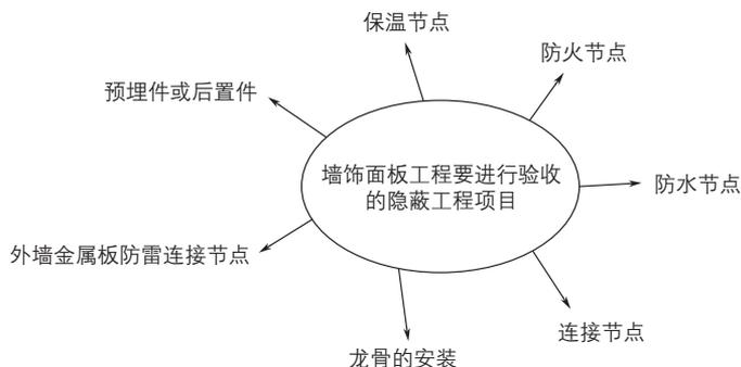
图10-13 墙饰面板工程要进行验收的隐蔽工程项目
