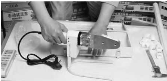
安装固定支架
