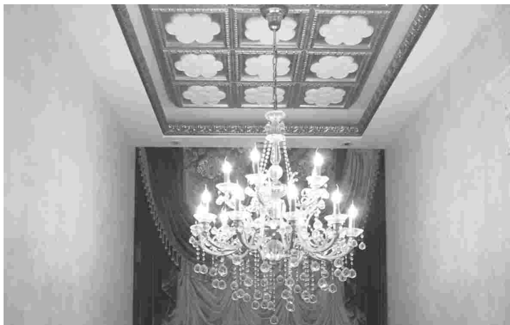
大型吊灯应固定在顶面上，而不应安装在龙骨上
