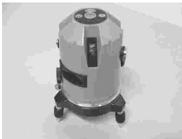
利用红外线水平仪检测地砖的平整度
